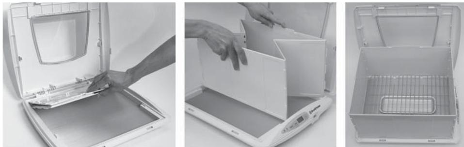
Placez le bac à eau au centre de la plaque chauffante. Placez la grille dans l'enceinte. Soulevez le couvercle vers le haut depuis les charnières arrière et placez-le sur les charnières broches au niveau du sommet arrière des côtés. Abaissez le couvercle à la position la plus serrée. Branchez le cordon d'alimentation dans l'étuve et ensuite dans une prise appropriée.
