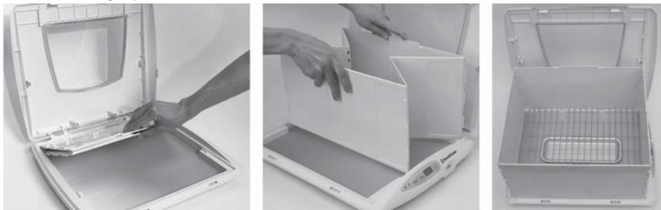
Поместите поднос для воды в центр нагревательной основы. Поместите металлическую подставку в ограждение опорами вниз. Поднимите крышку строго с задних петель и разместите её сверху получившейся коробки, помещая наводящие детали крышки в соответствующие пазы. Закройте крышку. Подсоедините провод в Пруфер и затем в подходящую розетку.
